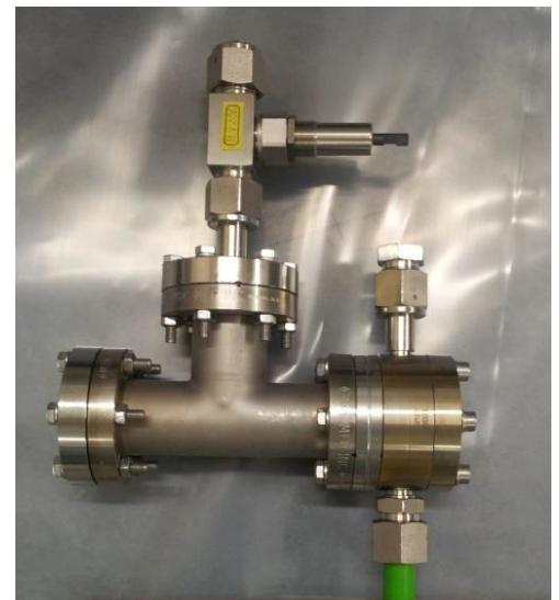
BIXS-Messzelle zur Messung von Tritiumoberflächenkontamination
