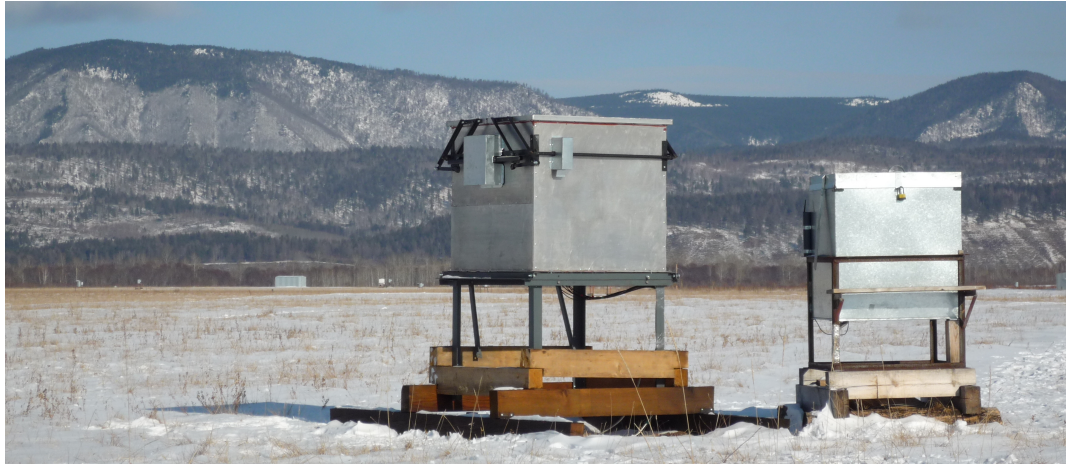
Рис. 7: Детектирующая станция установки HiSCORE.
