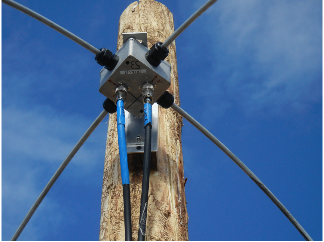
Рис. 9: Блок антенны с усилителем крупным планом.
