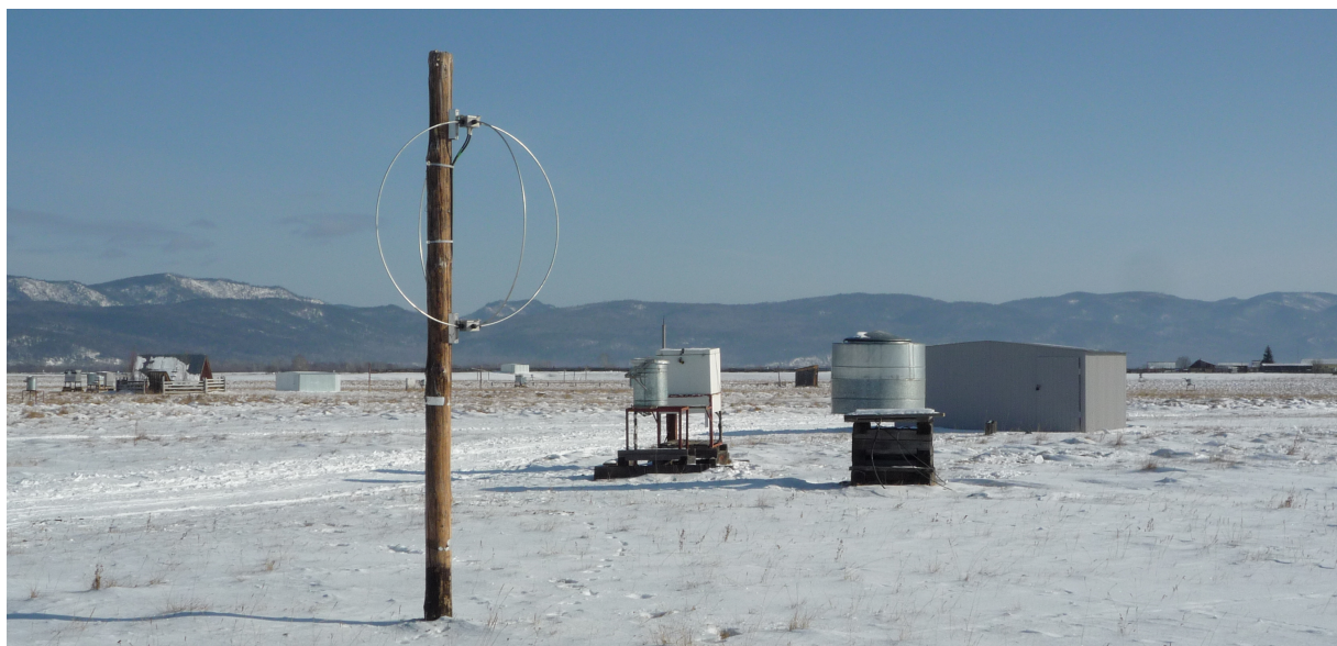
Рис. 4: Фото детекторов, расположенных в Тункинской долине. На переднем плане антенна Tunka-Rex, подключенная к центру кластера (белый ящик), рядом с которым расположен оптический модуль Тунки-133. В большом контейнере на заднем фоне расположены сцинтилляторы.
