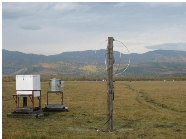
Abbildung 4.2: Im Vordergrund sieht man die aufgebaute SALLA-Antenne; links daneben ist ein Photomultiplier (zylinderförmig) und der Elektronikkasten. Im Hintergrund kann man noch weitere Photomultiplier erkennen [Sch10].
